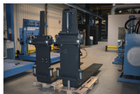
Fourches en 400x80 avec récupération de niveau
